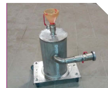
Odpieniacz do Wydzielonych Komór Fermentacyjnych (WKF)
